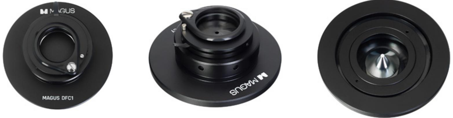
Ювелирный пинцет фиксирует камень в рабочей плоскости относительно конденсора.
